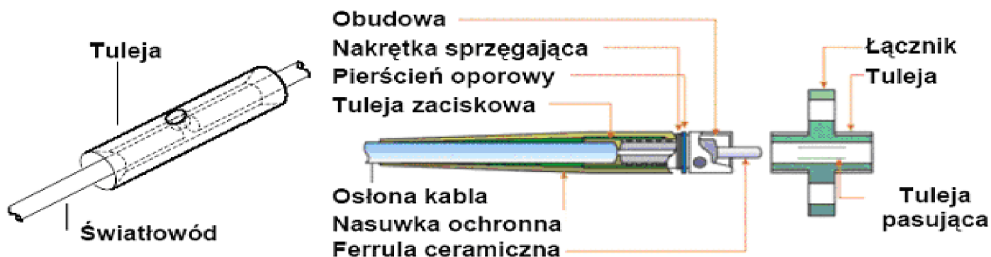
Budowa złączki światłowodowej
